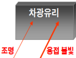
Fig.3.5. 경계영역의 도식화. 헬멧을 벗어야 하는 문제의 실체가 차광유리가 용접불빛과 조명빛을 차단하기 때문임을 명확하
