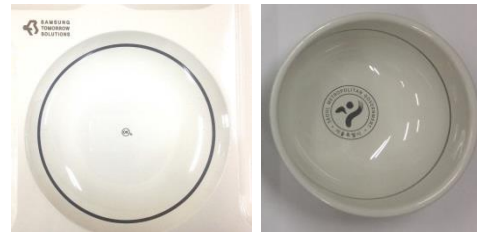
Fig. 9 식판 및 국그릇 측면 레이저작업 성공 사례
