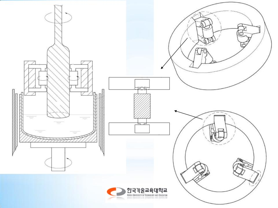
원통 형상의 단결정 성장 장치 내측에 형성된 적어도 둘 이상의 잉곳(ingot) 인상부를 포함하는 잉곳(ingot) 인상모듈을 제공함으로써, 잉곳(ingot) 제조 과정에서 발생할 수 있는 잉곳(ingot) 의 분리 또는 끊어짐을 방지할 수 있다. 그로 인해, 안정적으로 잉곳(ingot)을 제조할 수 있도록 하는 효과를 갖게 된다.
