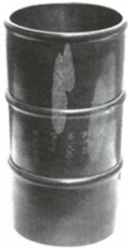
흙을 파서 깊이를 재던 종전의 방법 대신 '원통형 그릇'으로 내린 비의 양을 측정
